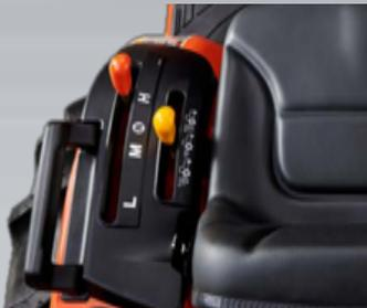
El B2320D tiene instalado un sistema de toma de fuerza trasera de tipo dependiente, con opción de seleccionar dos velocidades de giro 540/960 rpm.
